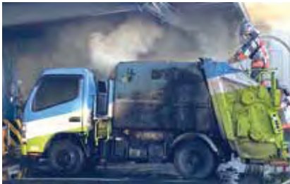
ごみ収集車火災被害状況
